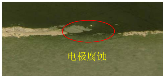
图 1 左端正电极被腐蚀现象图
